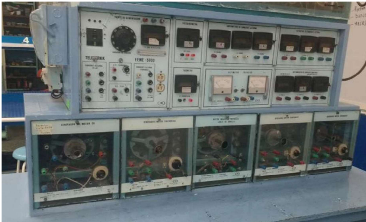
Figura 3.- Módulos de control de motores con elementos electromecánicos y variadores de velocidad de estado sólido.
